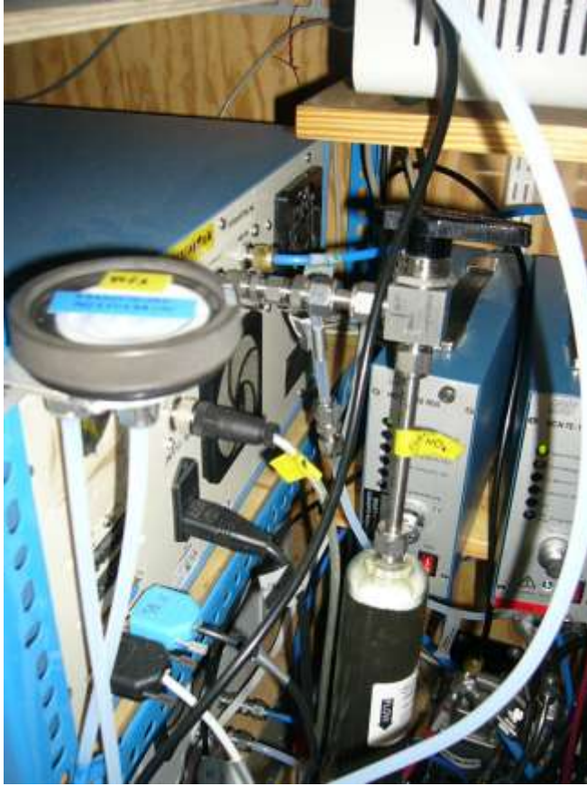
Kuva 2-31 Kaasuanalysointilaitteen pölysuodatinkotelo (musta kiekko kuvan vasemmassa yläkulmassa).
