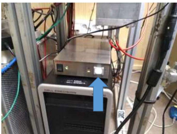
Kuva 2-10 X-ray source. Kun valkoinen valo palaa, laite on päällä.
