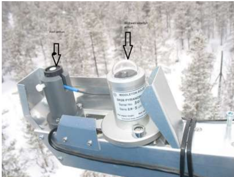
Kuva 2-27 Auringon säteilyanturit. Lämmitetty puhallusilma kulkee puomin sisällä ja purkautuu ulos anturien juuresta.
