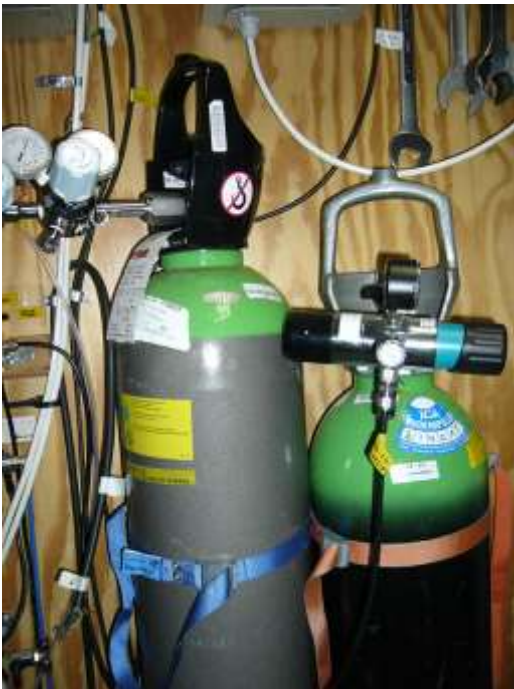
Kuva 9-1 Kalibroitikaasupullot (CO 2 /synteettinen ilma -seos ja synteettinen ilma) mökin sisällä.
