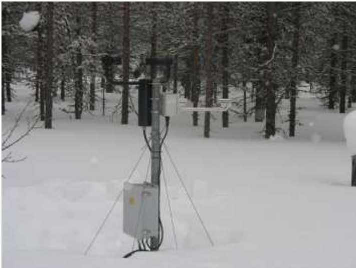
Kuva 2-26a Optiset sade- ja sääanturit LPM, Thies Clima (kirkas metalli) ja Biral (musta metalli).
