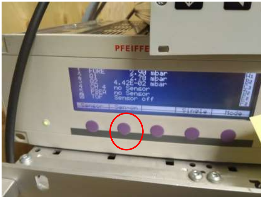
Kuva 2-8 Paininäyttö, josta luetaan päivittäin kolme painearvoa.
