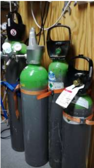
1 kpl kalibrintikaasupullo (Eddy), kalibrintikaasun CO 2 -pitoisuus annetaan pullon kaulassa riippuvassa sertifikaattilapussa (noin 400 ppm) ; nollakaasupullo (Eddy), jossa on synteettistä ilmaa (CO 2 -pitoisuus 0 ppm)
