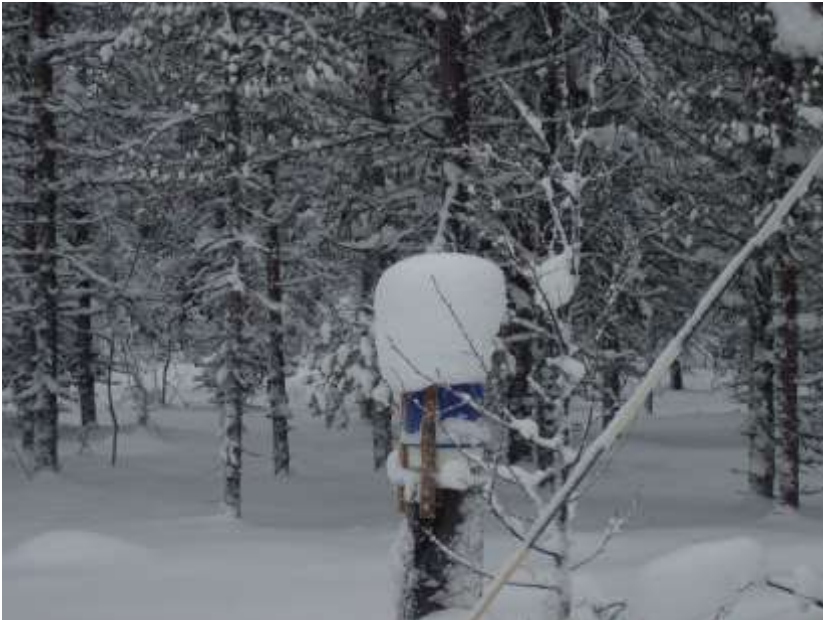
Kuva 2-32 Kiikkusademittari suojattuna talven lumisateita varten.
