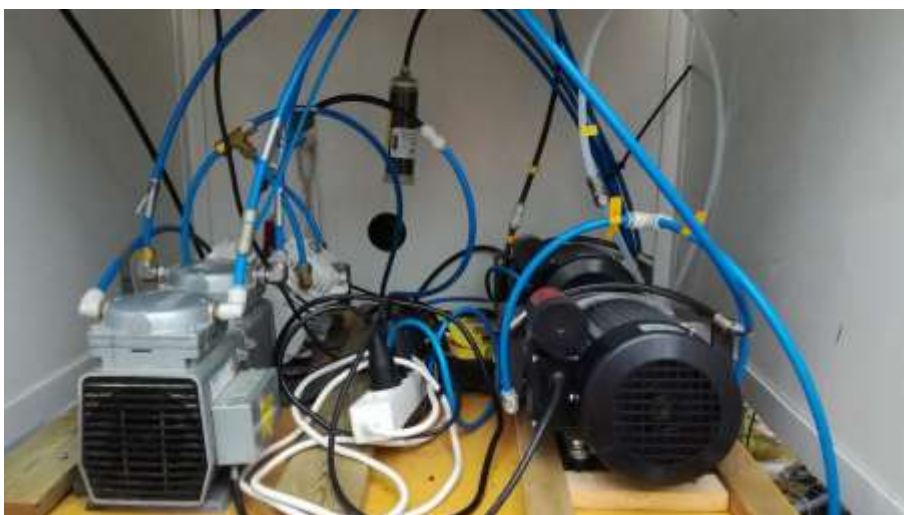
Kuva 8-2 Pumppuja pumppukopissa. Yläkuvassa on edessä oikealla kaasumittausten päävirtauspumppu (Dürr AG-132E). Takana vasemmalla on hiukkasmittauslaitteiston pumppu (Thomas) ja sen edessä toinen hiukkasmittauslaitteiston pumppu (Gast DAA). Huom! Yläkuvassa, takana kuvan oikeassa takakulmassa, oleva ty- penoksidianalysointin (NOx) näytevirtauspumppu (Dürr AG-0652E) on nykyisin uuden puolen pumppuhuoneessa. Alakuvassa on Eddy-mittauslaitteiston pumppu (Thomas 672) kaapin ylähyllällä.
