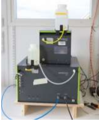
Kuva 5-9 A11 nCNC, PSM (alla), CPC (päällä), täyttöpullot molemmille laitteille, inlet-laatikko (laitteen ja seinän välissä).
