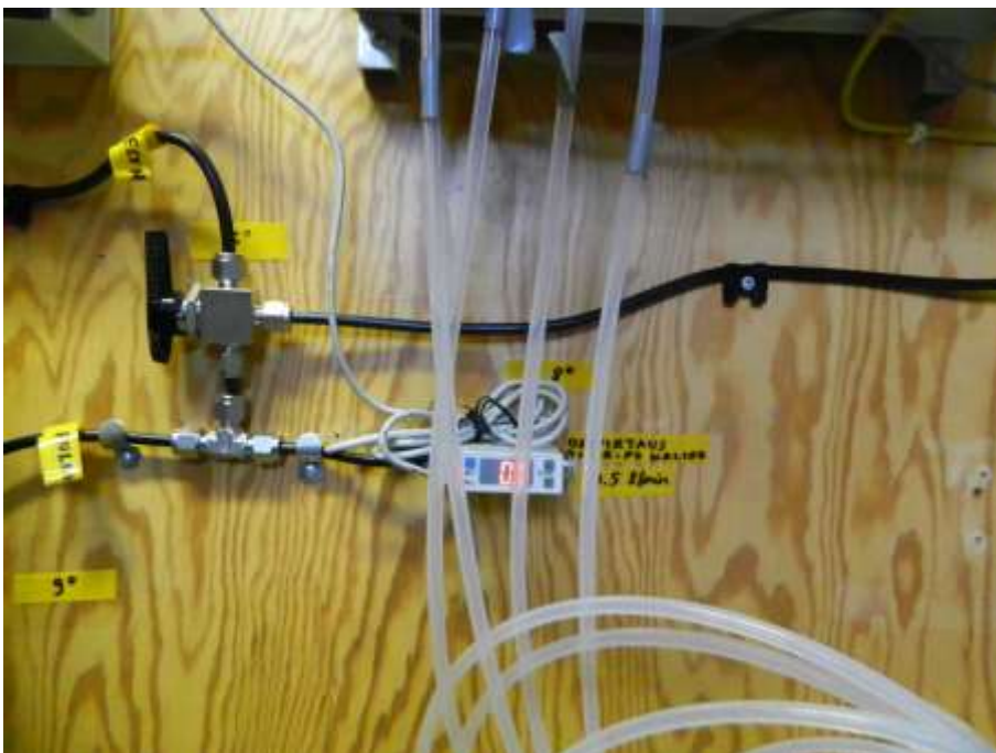
Kuva 9-2b Kyvetti Licorin kalibroinnissa käytettäviä/tarvittavia hanoja itäseinällä, numerokoodit keltaisissa teipeissä.
