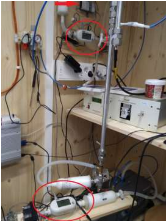
Kuva 25A Nephelometrin virtaus ja ohivirtauksen säätö.
