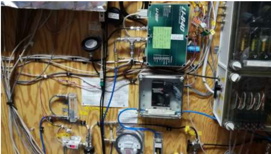
Kuva 9-2a Kyvetti Licorin kalibroinnissa käytettäviä/tarvittavia hanoja itäseinällä, numerokoodit keltaisissa teipeissä.
