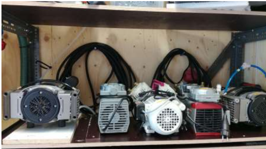
Kuva 8-3 Kuvassa vasemmaisın puoleisın pumppu on typenoksidianalysoittorin (No & NOx) näytevirtauspumppu (Dürr AG-0652E) on uuden puolen pumppuhuoneessa. Sen vieressä on erinäisiä varapumppuja.
