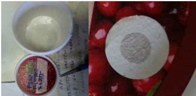
Kuva 5-7 PSAPin käytetyt filtrit laitetaan laitteen vasemmalla puolella olevaan muovipurkkiin. Filtrin tasainen värjäytyminen tarkistetaan filtrin vaihdon yhteydessä.
