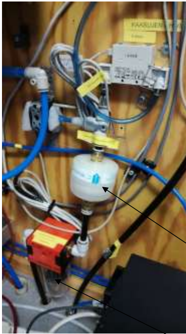
Kuva 2-3 Kaasunäytelinjan päävirtauksen vedenerotin (Hoerbiger CF-10) + pölysuodatin (Whatman).
