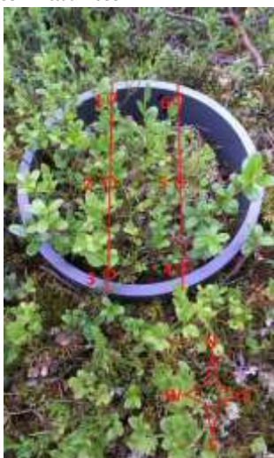
Kuva 10-1 Kauluksen mittaaminen: Mittauslinja on merkitty tussilla kaulukseen. Kaulus mitataan kuudesta kohtaa, jotka on merkitty kuvaan. Piste 1 on luoteiskulmassa ja piste 6 koilliskulmassa. Pisteitä 2 ja 5 varten kannattaa varata esim toinen viivotin, jota käyttää mittaustasona. HUOM! Arvot ovat positiivisiä, kun kasvillisuus nousee kauluksen yli ja negatiivisiä kun kasvillisuus on kauluksen reunan alapuolella.
