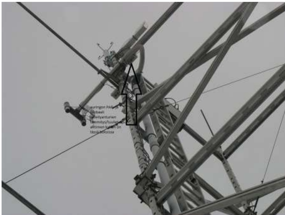
Kuva 2-28 Auringon säteilyanturien lämmityspuhallin.
