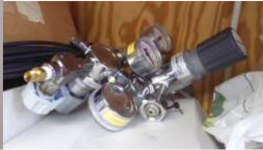
rotametri/säätöventtiili ja letku; paineenalentimet CO 2 -kaasulle ja nollakaasulle (teippimerkintä)
