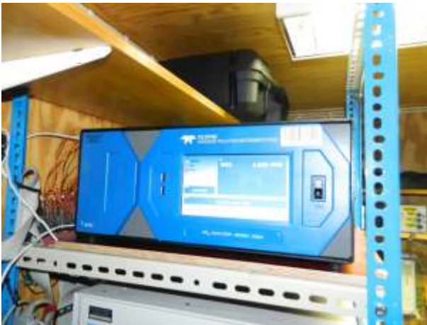
Kuva 6-1 Kaasuanalysointilaitteet CO, NO & NO x , O 3 ja SO 2 yläkuvassa ja NO 2 -analysointilaitteet alakuvassa.
