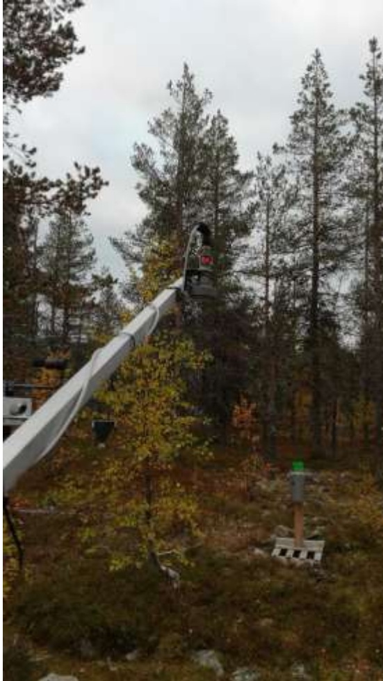
Kuva 2-8b Lumensyvyyssanturi (kaltevan puomin päässä oleva mittalaite, jossa punainen etäisyyden numeronäyttö).
