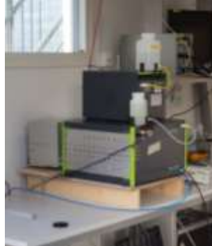
Kuva 5-9 A11 nCNC, PSM (alla), CPC (päällä), täyttöpullot molemmille laitteille, inlet-laatikko (laitteen ja seinän välissä).
