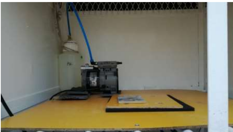
Kuva 8-2 Pumppuja pumppukopissa. Yläkuvassa on edessä oikealla kaasumittausten päävirtauspumppu (Dürr AG-132E). Takana vasemmalla on hiukkasmittauslaitteiston pumppu (Thomas) ja sen edessä toinen hiukkasmittauslaitteiston pumppu (Gast DAA). Huom! Yläkuvassa, takana kuvan oikeassa takakulmassa, oleva ty- penoksidianalysointin (NOx) näytevirtauspumppu (Dürr AG-0652E) on nykyisin uuden puolen pumppuhuoneessa. Alakuvassa on Eddy-mittauslaitteiston pumppu (Thomas 672) kaapin ylähyllällä.
