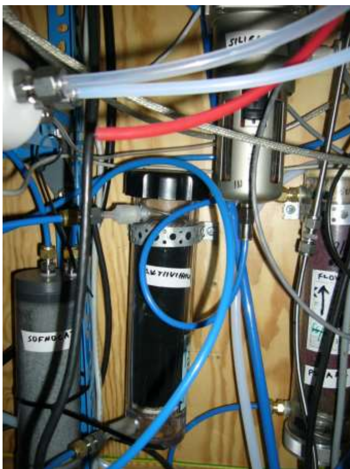
Kuva 9-5 Puhdistuskemikaalipatruunat nollailman tuottamista varten.
