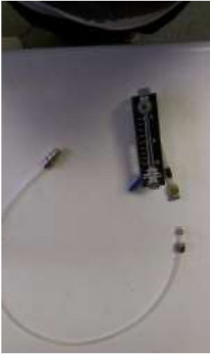
rotametri/säätöventtiili ja letku; paineenalentimet CO 2 -kaasulle ja nollakaasulle (teippimerkintä)
